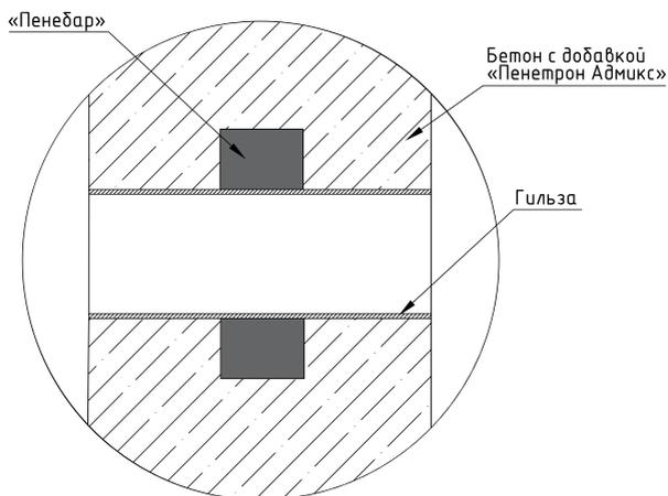
Рисунок 9.3 — Схема гидроизоляции гильзы для ввода инженерных коммуникаций
