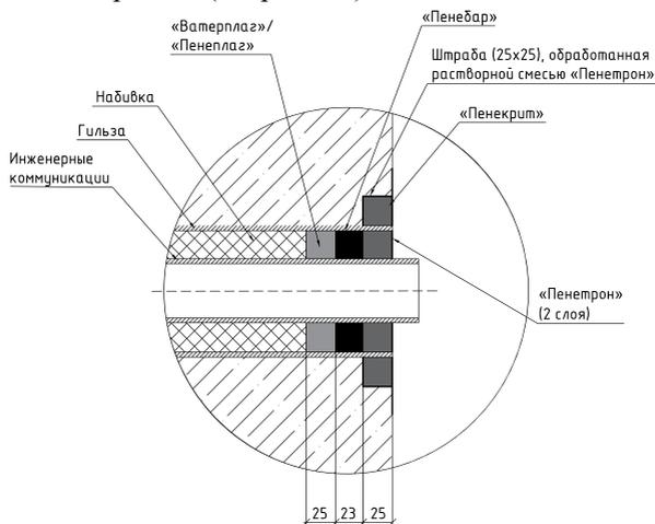
Рисунок 8.6 — Схема гидроизоляции мест ввода инженерных коммуникаций (вариант 1)
