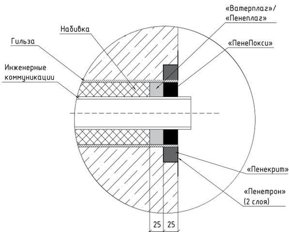
Рисунок 8.7 — Схема гидроизоляции мест ввода инженерных коммуникаций (вариант 2)
