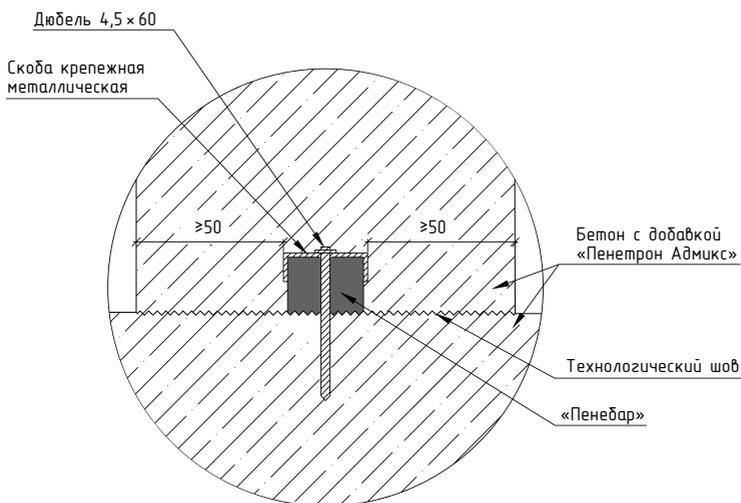
Рисунок 9.2 — Схема гидроизоляции швов бетонирования при монолитном строительстве
