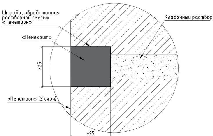
Рисунок 8.4 — Схема гидроизоляции шва между бетонными блоками (ФБС)
