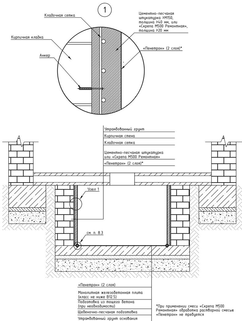
Рисунок 8.9 — Схема гидроизоляции каменных конструкций изнутри
