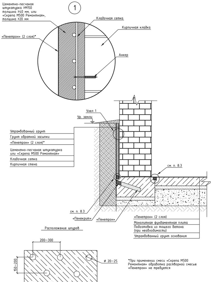
Рисунок 8.8 — Схема гидроизоляции каменных конструкций снаружи
